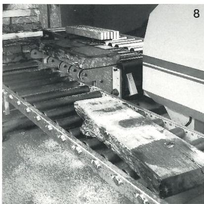
7 Beschickungs- und Ausrichtsysteme von Interholz Raimann rationalisieren die Arbeitsabläufe. Posimat I ist ein System mit elektronischer Waldkantenerkennung. Posimat II zentriert besäumte und unbesäumte Werkstücke. Posimat III ist für besäumte Brettware konzipiert.
