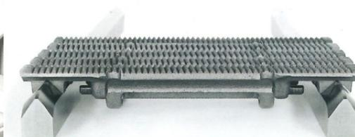
**Beidseitige Prismenführung:** Sie sorgt immer und während der gesamten Lebensdauer der Kreissäge für einen exakten Parallelschnitt und damit für bessere Holzausbeute und höchste Schnittpräzision.
