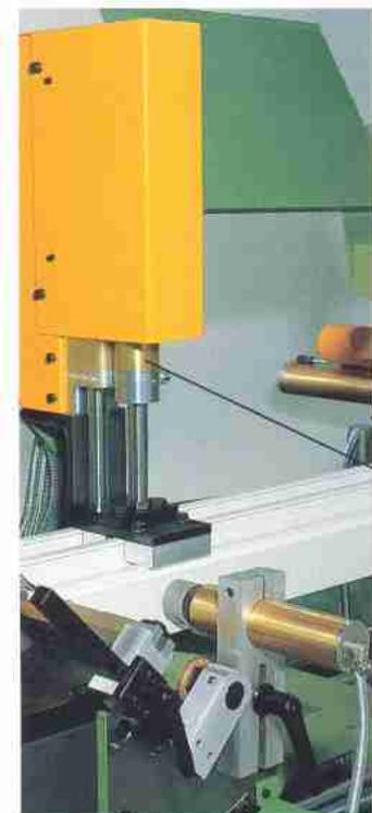
Gleichmäßiger Sägeblattvorschub und damit hohe Schnittqualität wird über einen **hydropneumatisch** betätigten **Vorschub-Zylinder** erreicht. Für die Bearbeitung von Aluminium unbedingt erforderlich!
