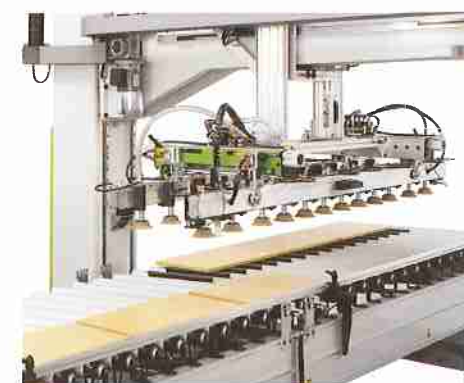
Beispiel für Plattenbeförderung in doppelter Reihe.
