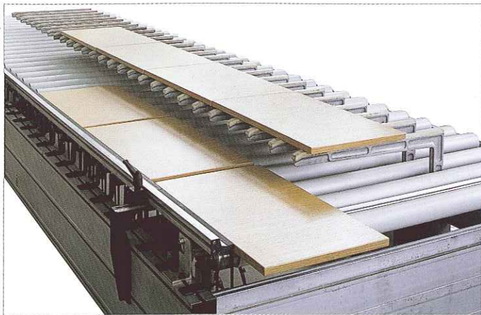
Rollenbahn mit Kammsystem zur doppelreihigen Plattenbeschickung
