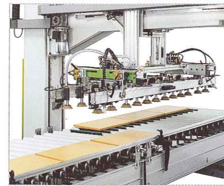
Beispiel für Plattenbeförderung in doppelter Reihe.
