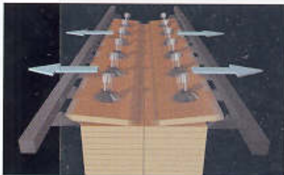
Double row panel separation for loading. Détachement des panneaux double file à l'empilage.
