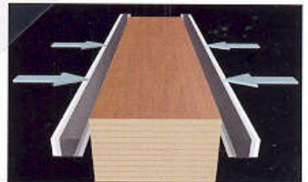
Panel adjustment system during unloading. Système d'ajustage des panneaux au défilage.
