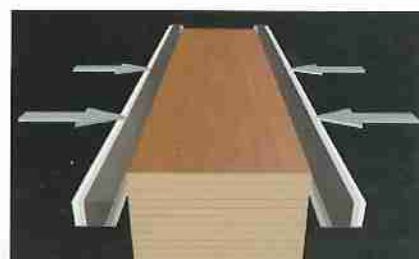
Système d'ajustage des panneaux au défilage Sistema de ajuste paneles para la descarga.
