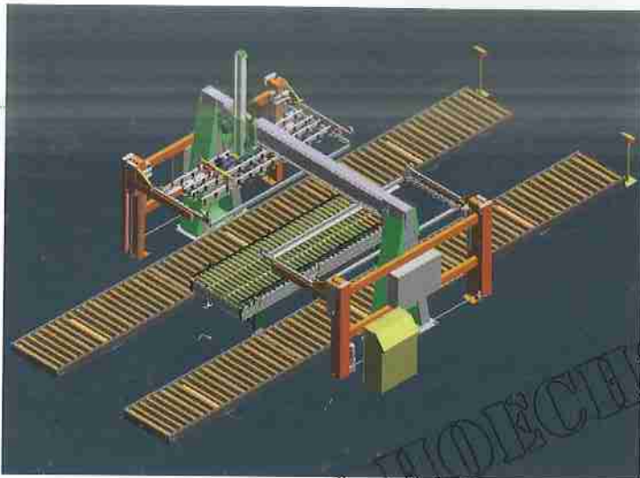
Empileur Winner avec dispositif de détachement motorisé. Cargador Winner con separador motorizado.
