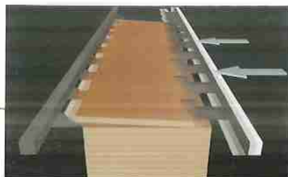
Détachement des panneaux simple file à l'empilage. Separación paneles fila individual para la carga.
