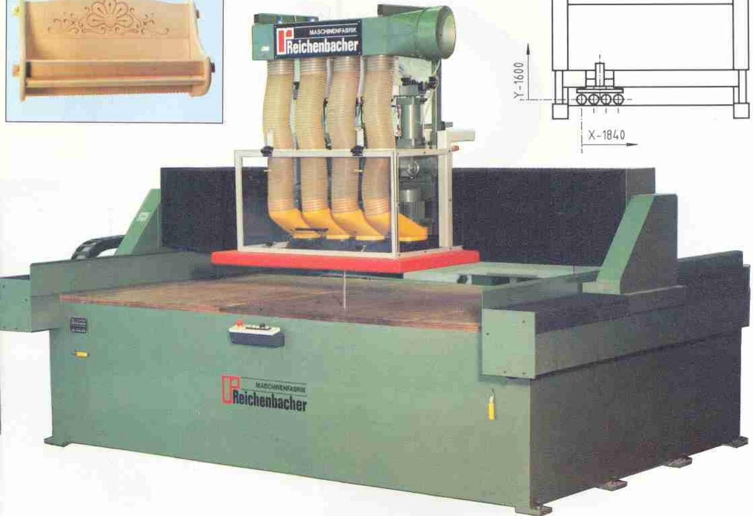
CNC-gesteuerte Fräsmaschine **RANC 206 AM** für Schulungszwecke und Kleinteilefertigung, versehen mit 2 Fräsmotoren (4,8 kW/6,5 PS) und einem Arbeitstisch 1100 x 650 mm. Die Maschine ist voll gekapselt und hat das **GS-Zeichen** mit dem Zusatz "staubgeprüft".
