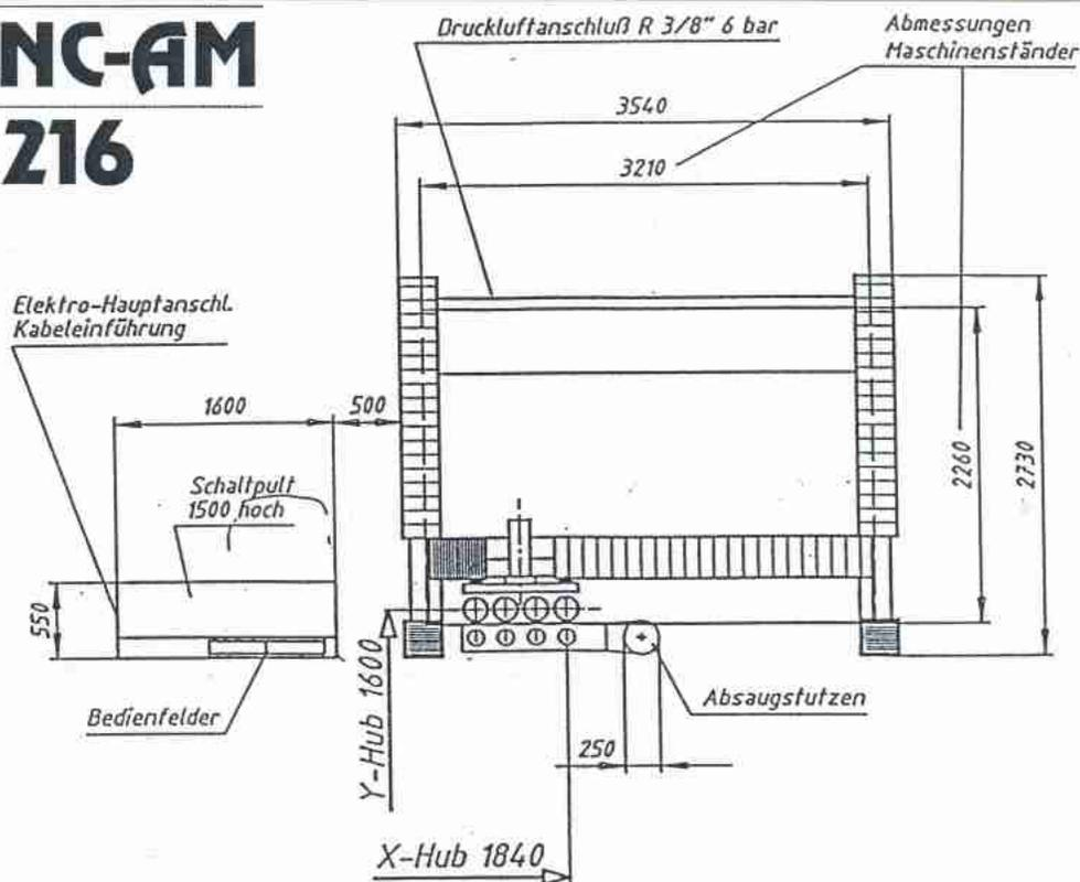
Maschinenhöhe mit Absaugung 2650 mm
