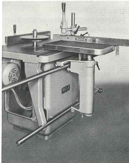
Abb. 3 zeigt eine REX Type 54-D mit Rolltisch beim Einsatz als Zapfenschneid- und Schlitzmaschine.
