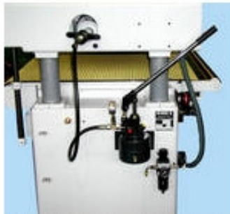
schraubenlose Hobelwelle mit Hydropumpe
