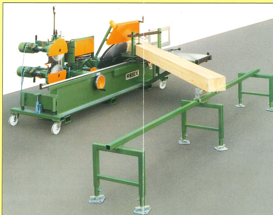
Abb. 4 zeigt die rationelle Bearbeitung langer und schwerer Balken unter Zuhilfenahme des schweren Werkstück-Auflagebockes mit mitlaufender Schwerlastrolle (Mehrpreis)
