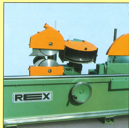
Abb. 2: Schwere Einschnittkreissäge/Schlitzaggregat (nach vorne schwenkbar)
