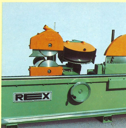
Abb. 2 Schwere Einschnittkreissäge mit der unteren und oberen Absetzkreissäge.
