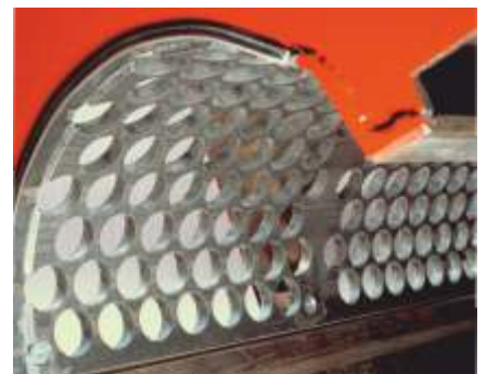
Le facteur de broyage requis du matériel alimenté se laisse déterminer par l'utilisation de tamis ajustables de manière variable grâce à des perçages adaptés.
