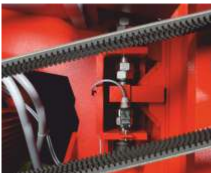
Pack sécurité avec commutateur de fin de course du moteur et compteur de réversion
