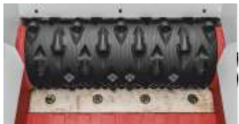
Rotor-Version 8 (30 mm Messer-Ø)
