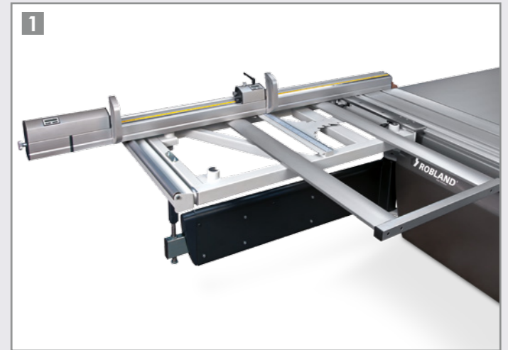
Der Queranschlag-Auslegertisch Der neue grosse Auslegertisch mit schrägstellbarem Queranschlag und Gradskala
