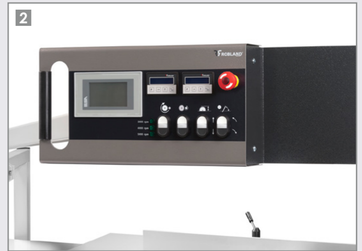
Bedienpult mit 7" Touchscreen auf Augenhöhe für die Steuerung von die Parallelanschlages. Mit optionellen Digipack X1 (Digitale Auslesung vom Schräg-und Höheneinstellung vom Sägeblatt)
