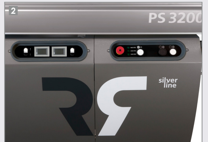
Motorische Höhenverstellung, Sägeblatt- Schragestellung und optionellen Digi Pack (Digitalanzeige Schrägestellung und Höhenverstellung Sägeblatt)
