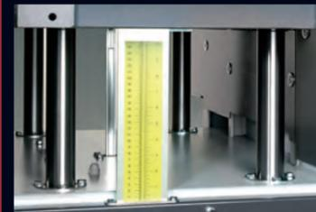
Elektrische Höhenverstellung des Dickentisches. Feineinstellung mittels Handrad.
