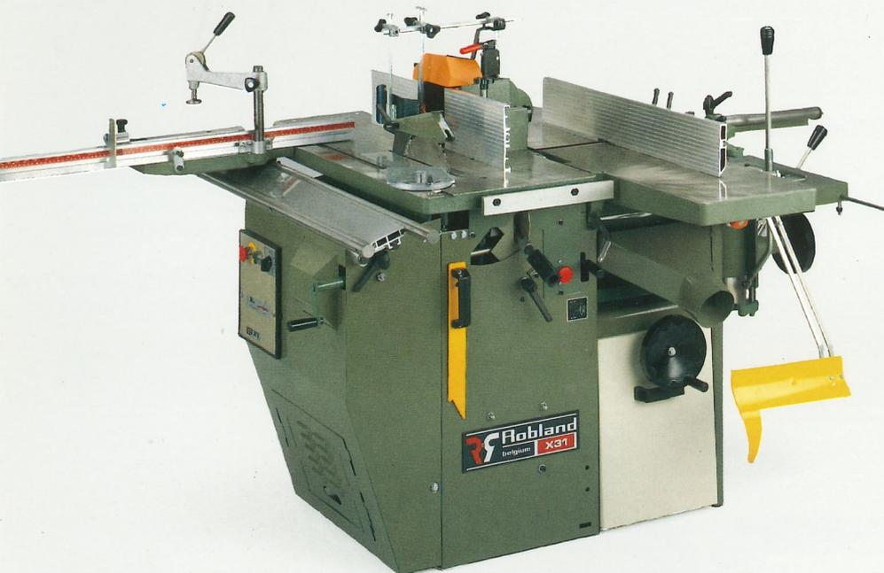
Die 5fach komb. Robland Holzbearbeitungsmaschine X 260 und X 310 sind echte Universalmaschinen, die weltweit ihre Anerkennung gefunden haben. Durch die Ausstattung der Maschinen mit 3 Motoren à 2,3 kw geht das Umrüsten von einem Arbeitsgang zum anderen sehr schnell vonstatten und durch ihre kompakte Bauweise beanspruchen sie wenig Platz und sind wenn sie auf dem als Sonderzubehör angebotenen Drehkranz montiert werden, auf kleinstem Raum für alle Funktionen gut zugänglich.
