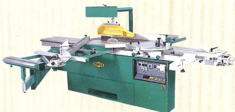
ФОРМАТООБРІЗНИЙ PF400E нахил пил до 45°, діаметр 400мм, частота обертання пили - 3.200, 4.600 об./хв., потужність - 5,5кВт / 0,5кВт
