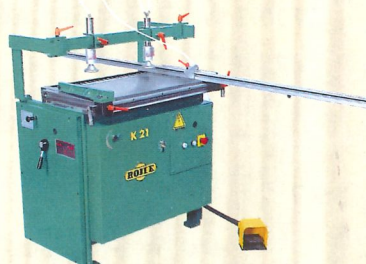
K21 - СВЕРДИЛЬНИЙ БАГАТОШПИНДЕЛЬНИЙ розмір столу 860x500 мм, кількість шпінделів 21 частота обертання 2.800 об./хв., тиск повітря 0,6-0,8МПа, електродвигун 2 кВт, нахил шпінделів 0-90 град.
