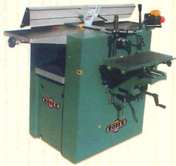
ФУГУВАЛЬНО-РЕЙСМУСНИЙ MSP310 ширина обробки - 310мм, висота обробки - до 200мм, потужність - 2.2 кВт, 4 ножі, швидкість подачі - 5м/хв.
