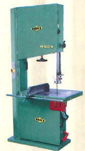
СТРІЧКОПИЛЬНИЙ PP800M частота обертання пили - 715 об./хв., діаметр шківів - 800мм, висота обробки - 500мм, нахил столу - до 45°
