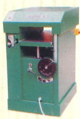
РЕЙСМУСНИЙ MR315 ширина обробки - 310мм, висота обробки - 4..230мм, потужність - 2,2 кВт, швидкість подачі - 8м/хв.
