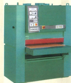
Калібрувально - шліфувальний G950-2 (G1100-2, G1 1300-2) max. ширина деталі 950 (1100, 1300) мм, max./min. товщина деталі 160/3 мм, швидкість шліфування 18м/хв., потужність 75 (11, 15) кВт.
