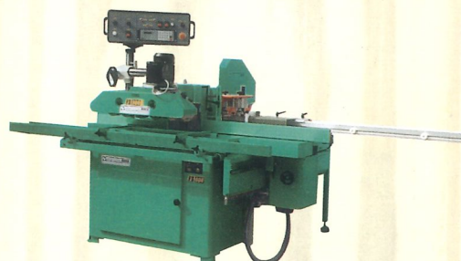
Фрезерний для виробництва вікон max. діаметр фрез 320 мм, потужність шипування і профілювання 7,5 - 12,5 кВт, діаметр пили 350 мм, потужність 2,2 кВт.
