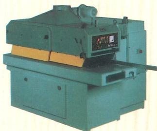
Багатопильний C250 (C320) max. розмір заготовки 250 x 120 (320 x 120) мм, max. віддаль між крайніми пилами 240 (300) мм, швидкість подачі 5 - 30 м/хв., потужність (11 - 15 - 18 (22-29) 36 - 44) кВт.
