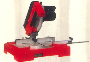
PR300 / 280 - ПЕРЕНОСНИЙ ТОРЦЮВАЛЬНИЙ ПРИСТРІЙ пила 254x2,5x30мм, частота обертання 3.800 об/хв., однофазний електродвигун 230 В/1,2кВт, маса 15 кг
