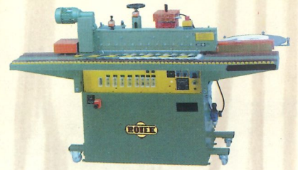
OH 111SL (SLK) - КРОМКООБЛИЦЮВАЛЬНИЙ розміри деталей: min. 260 x 75 (90) x 10(45) мм, швидкість подачі, м/хв. - 11, частота обертання фрез - 18 тис. об./хв. потужність - 3,1 кВт
