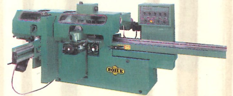
ЧОТИРИСТОРОННІЙ ПРОФІЛЬНИЙ CPF220 max перетин деталей 220x120мм, min 20x7мм, min довжина 320мм
