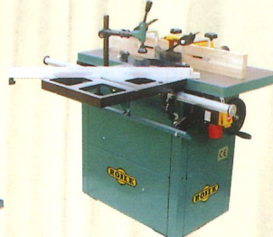
ФРЕЗЕРНИЙ FSN300F нахил шпинделя - 0°, частота обертання 1,4 - 3,5 - 6 - 8 тис. об./хв., потужність 2,2 кВт, каретка CV1C
