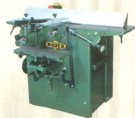
ФУГУВАЛЬНО-РЕЙСМУСНИЙ MSP415 ширина обробки 410мм, висота обробки 4 - 230мм, потужність - 3 кВт, можливість приєднання довального пристрою
