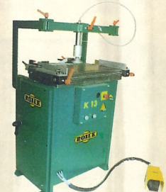
K13 - СВЕРДИЛЬНИЙ БАГАТОШПИНДЕЛЬНИЙ розмір столу 750x500 мм, кількість шпінделів 13, частота обертання 2.800 об./хв., тиск повітря 0,6-0,8МПа, електродвигун 1,1 кВт, нахил шпінделів 0-90 град.
