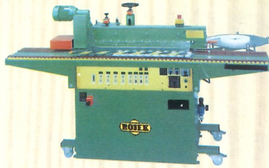
OH 111S - КРОМКООБЛИЦЮВАЛЬНИЙ розміри деталей: min. 175 x 75 x 10 мм, швидкість подачі, м/хв. - 9, частота обертання фрез - 18 тис. об./хв. потужність - 3кВт
