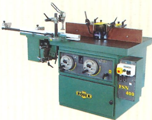
ФРЕЗЕРНИЙ FSN400 нахил шпінделя -5-45°, частота обертання - 3, 4, 8 тис.об./хв., підйом шпінделя - 230мм, потужність - 4 кВт, каретка CV4, автоподавач
