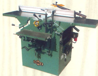
ФУГУВАЛЬНО-РЕЙСМУСНИЙ MSP410 ширина обробки - 410мм, висота обробки - до 230мм, потужність - 3 кВт, 4 ножі, швидкість подачі - 7,6м/хв.
