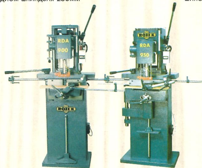
RDA 950 (900) ЛАНЦЮГОВО-ДОВБАЛЬНИЙ max глибина довбання 180мм, переміщення супорту 170 (170)мм, нахил столу +-45 град., зсув 95 (90)мм, електродвигун 2,2 (1,6) кВт
