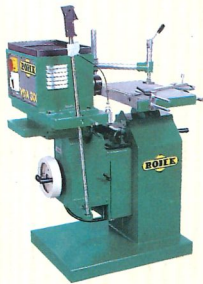
СВЕРДИЛЬНО-ПАЗУВАЛЬНИЙ VDA300 розмір столу 565x315мм, нахил столу 45°, частота обертання 3.000 об./хв., потужність - 1,5 кВт
