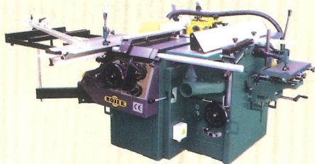
ПЯТИОПЕРАЦІЙНИЙ KPS300 фугування, рейсмусування, пиляння, фрезерування, свердління (довбання) нахил пили D:300мм до 45 град., 4 частоти обертання фрези, ширина стругання 310мм, висота обробки 230мм, потужність 3x2.2 кВт, можливість приєднання довального пристрою
