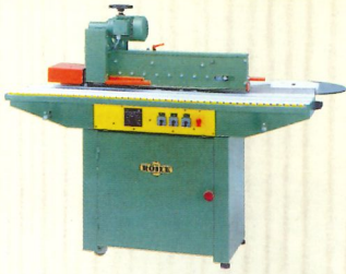
OH 109S - КРОМКООБЛИЦЮВАЛЬНИЙ min довжина - 250мм, min ширина - 65мм, min товщина 10 мм, max товщина 42 мм, електродвигун 3,7 кВт, маса 168 кг
