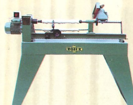
ТОКАРНИЙ з КОПІРОМ SH1 діаметр обробки - 8..300мм, довжина обробки - 900мм, п'ять частот обертання - 670 - 2950 об./хв., потужність - 1,5 кВт
