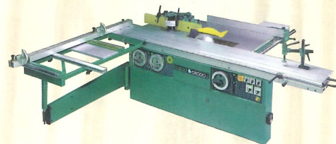
Фрезерно - форматобрійний SC3200 з підрізною пилою довжина різку 2660 - 3260 - 3860 мм, висота різку 130 мм, нахил пил до 45°, частота обертання 3,2 - 4 - 6 тис. об./хв., потужність 4 кВт.
