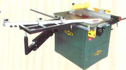
КРУГЛОПИЛЬНИЙ RT300 з ПІДРІЗНОЮ ПИЛОЮ висота обробки при куті пили 90° - 105мм, 45° - 70 мм, частота обертання пили - 4.340, 8.300 об./хв., потужність - 3 кВт, каретка CV2 - 1.200x845мм, автоподавач
