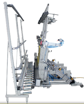
RU-MKSE-P4R // Rollladenkasten-Montage-Kipptische mit pneumatisch höhenverstellbarer Auflageplattform und Übergabe-Rollenbahn. Tragkraft 400 kg.
