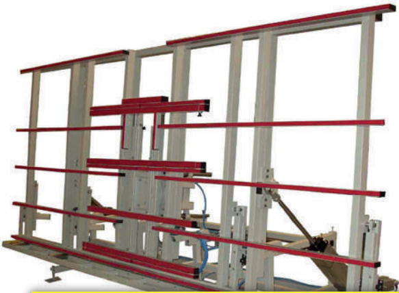
RU-MK // Kipptisch mit Dreh-Hubstation
