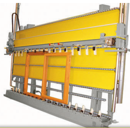
RU-SE-HA // Hubstation mit Spanneinheit von oben
