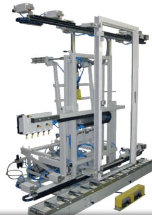
RU-MKS // Kipptisch mit Spanneinrichtung und 83°- bis 90°-Kippstellung
