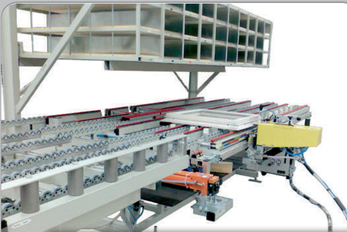
RU-BM // Flügelbeschlagsmontage mit absenk-barem Rollentisch u. Drehkreuz
