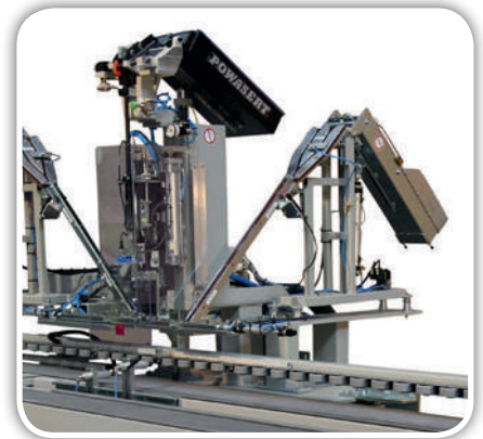
RU-CS-ZAE // Aluhalter-Setzautomat am Einzelstab mit autom. Vorschub
