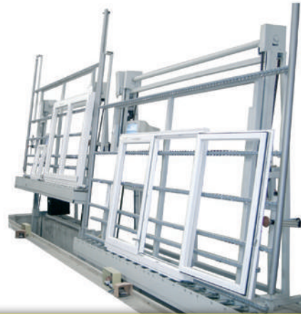
RU-SE // Hubstation m. elektromotorischer Hubeinrichtung über u. unter d. Boden
