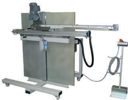
RU-AH-T // Auflegehilfe zum Auflegen von langen Profilen
