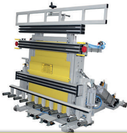
RU-MKSE-P4R // Rollladenkasten-Montage-Kipptische mit pneumatisch höhenverstellbarer Auflageplattform und Übergabe-Rollenbahn. Tragkraft 400 kg.
