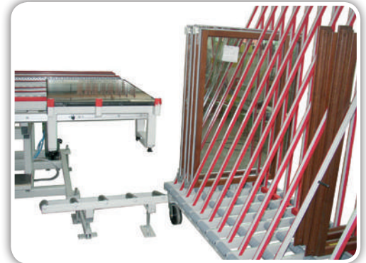
RU-FMOG // Flügelmontagestation mit Beschlagstanze u. Schraubautomat
