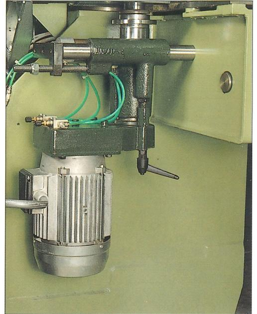
18 - Grupo acanalado de la fayeaba (sobre pedido). Con o sin dispositivo para el posicionamiento vertical automático en dos posiciones diferentes.
