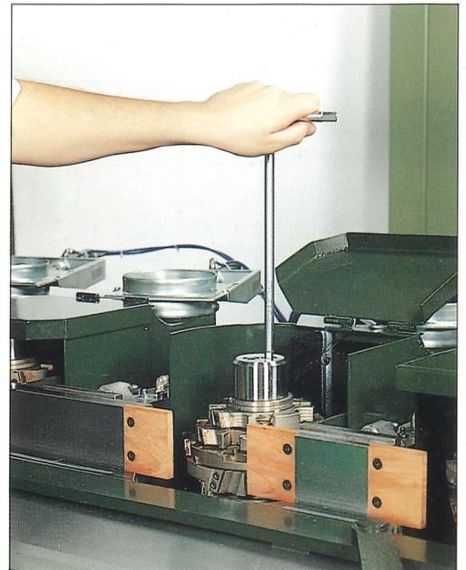
20 - Desmontaje herramientas: los ejes no contrasoportados permiten un desmontaje fácil y rápido de la herramientas.
