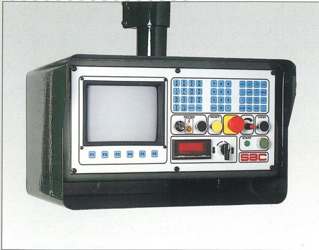
17 - Panel de mandos con monitor para el control constante de todas las funciones de la máquina y del nombre de la pieza en fase de elaboración; suspendido y desplazable en la posición más idónea para el operador.
