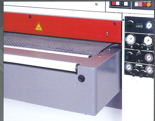
Prolunga piano anteriore e posteriore con rulli per facilitare lo scorrimento dei pezzi
