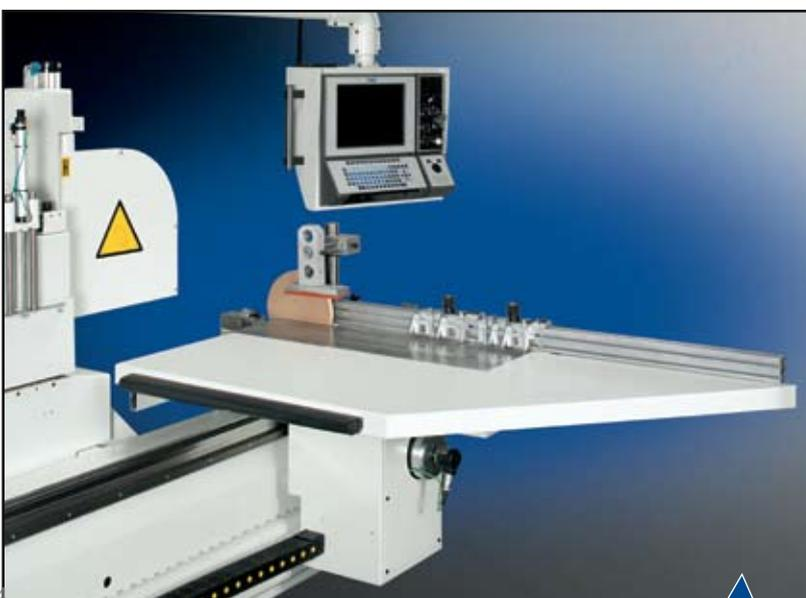
Carro di tenonatura montato su doppie guide a sfere scorrevoli su rotaie temprate e rettificata. Motorizzazione tramite pignone e cremagliera di precisione. Velocità variabile elettronicamente.
