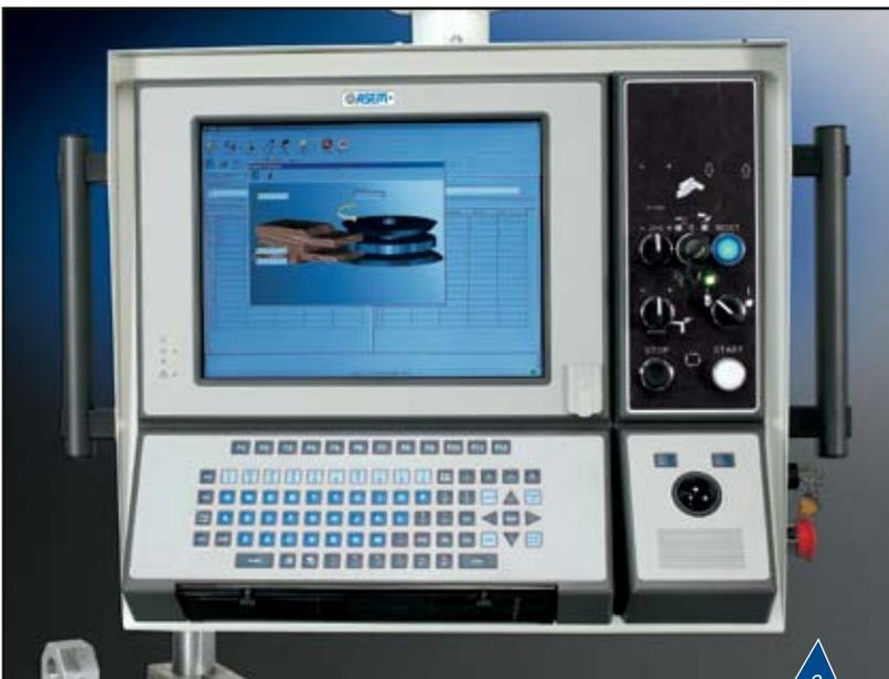
Pannello di comando per il controllo di tutte le funzioni macchina, trasmissione dei dati di lavoro tramite Floppy disk. Cd Rom. Possibilità di connettere qualsiasi periferica plug and play Windows. Possibilità di connettersi a tutte le reti LAN con tutti i protocolli supportati da Windows XP Pro.
