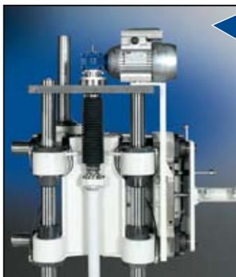
*Albero di precisione con lunghezza 320 mm, diametro 50 mm e corsa 295 mm.*
