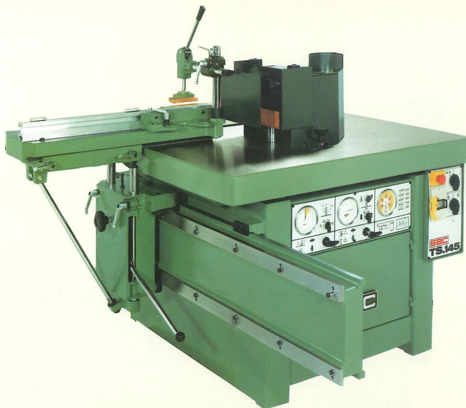
Die schwere Stahlkonstruktion des Maschinenständers ist die Voraussetzung für einwandfreien, ruhigen und schwingungslosen Lauf. Maschinengewicht ca. 1050 kg.
