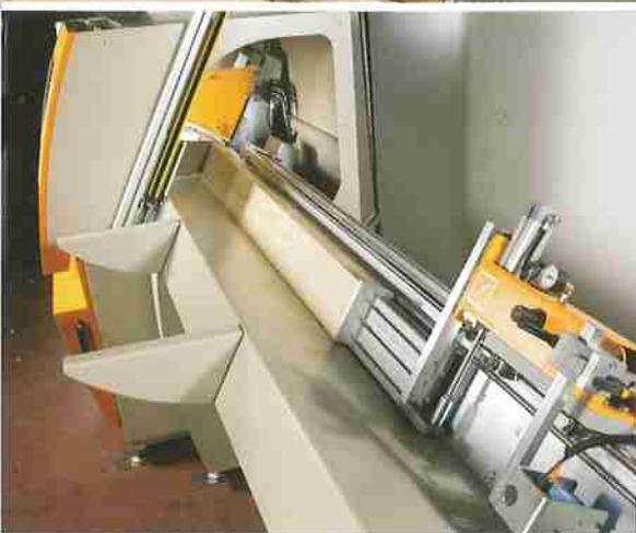
**Davvero Robusta:** Sezione di taglio fino a 350 mm di larghezza e mm 160 di altezza, trave di scorrimento-supporto spintore da 200x150 mm rivestita da acciaio di grosso spessore antiusura, potente cinghia di traino dimensionata per carichi fino a 805 Kg.
