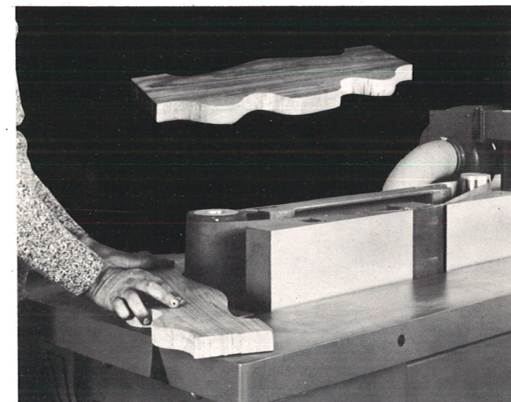
Levigatura superficie curva Sanding of curved surface Ponçage d'une surface courbe Schleifen von gewölbten Fläche
