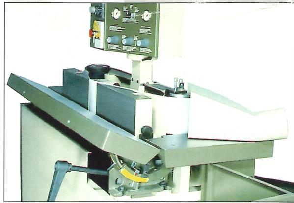
Der Zusatzstisch mit Gummiwalzen eignet sich ideal zur Bearbeitung von geformten Werkstücken (Sonderzubehör).
