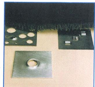
**Timesavers Inc. entwickelte die Rotationsdiskus-Maschine mit 1 Aggregat (RD), die alle Kanten eines Werkstückes aus Metall in alle Richtungen, in einem Durchgang entgraten kann mit gleichzeitig verfeinertem, beliebigem Oberflächenfinish.**
