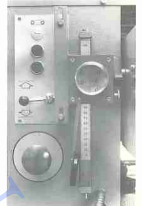
Einstellen auf 1/10 mm Noniusdicke unter Benutzung eines Vergrösserungsglasses.
