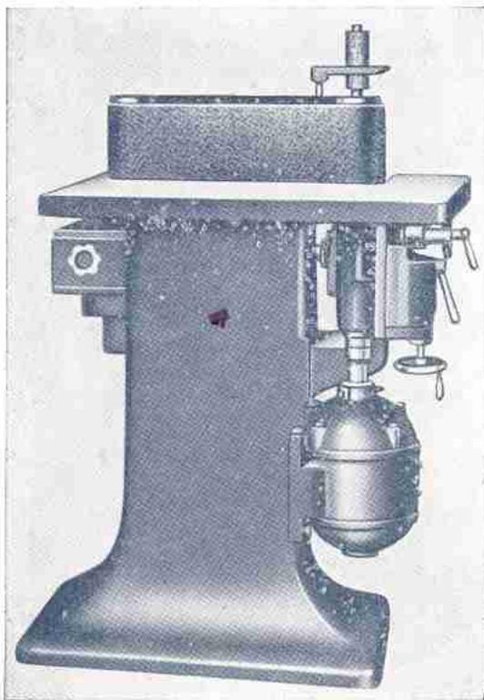
Schleifmaschine mit vertikalem Schleifband
