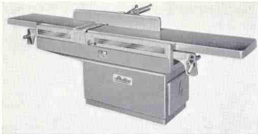
Genauigkeits-Abricht-, Falz- und Fügehobelmaschine Typ AH-41
