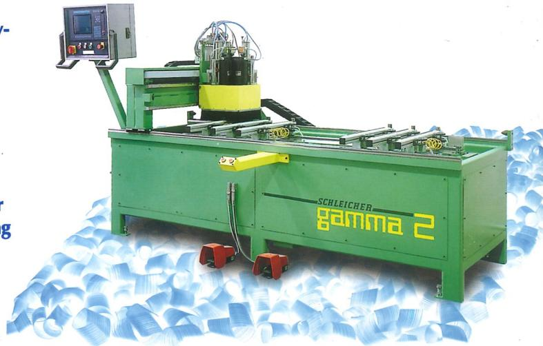
**GAMMA 2** Eine auf den Handwerksbetrieb zugeschnittene Lösung zum Bohren, Nuten und Fräsen - als leichter Einstieg in die CNC-Technik, einsetzbar in der Einzel- und in der Serienfertigung
