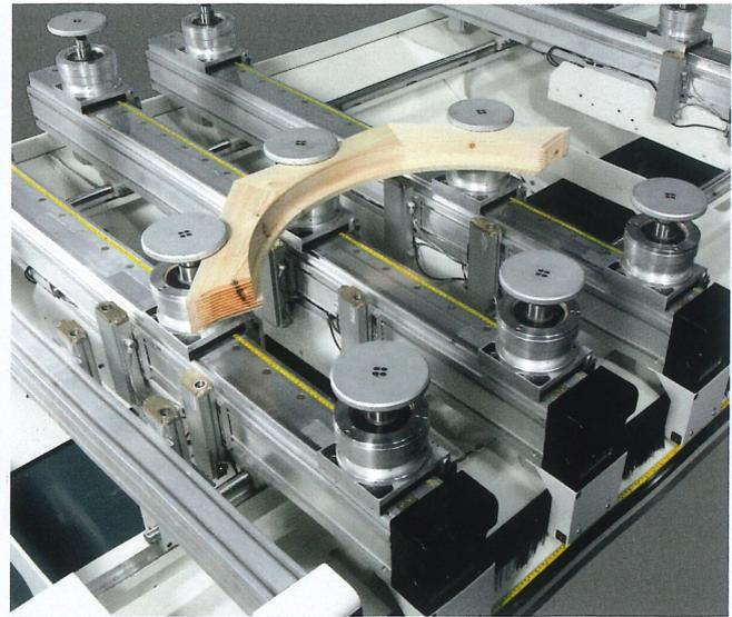
Perfekt zur Vor- und Fertigbearbeitung von Fenstern und Türen. Alle Auflagen sind mit Reinigungsdüsen versehen, die die Späne im Durchlaufbereich sowie im unteren Bereich der Werkstückeinspannung beim Wechsel der Spannzylinder entfernen.
