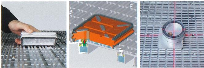
Das Einrüsten lässt sich praktisch und einfach durchführen; das exklusive Aluminiumprofil ist mit Nuten und Bohrungen versehen, die zur optimalen Positionierung jeder Art von Auflage ausgelegt sind. Noch schneller geht es mit einem Lasersystem, das die exakte Positionierung der Sauger ermöglicht.
