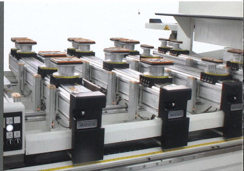
Der Arbeitstisch mit manueller Bedienung ist in der Version „Start“ und „Pilot“ erhältlich. Durch das Schnellspannsystem bietet er maximale Einsatzfreiheit. Spannzylinder und Sauger können schnell hinzugefügt oder entfernt werden, um stets eine optimale Werkstückspannung zu gewährleisten.
