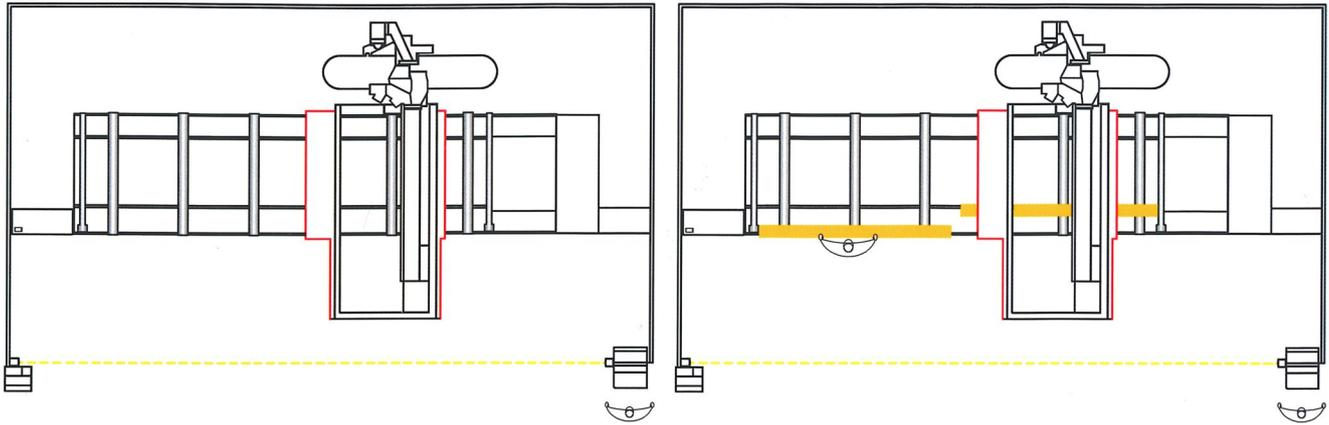
Das Sicherheitssystem „Pro Speed“ besteht aus einer Lichtschranke, die den Aufgabebereich begrenzt und aus Berührungssensoren am Fahrportal. Mit diesem System kann die maximale Positioniergeschwindigkeit von 90 m/min. aller Maschinenachsen genutzt werden, wenn sich das Werkzeug in gesicherter Position befindet.
