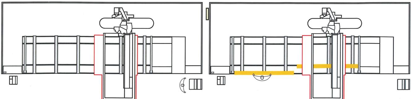
Das Sicherheitssystem „Pro Space“ besteht aus Berührungssensoren am Fahrportal, um die Tiefenmaße deutlich zu reduzieren und die maximale Positioniergeschwindigkeit der X- und Z-Achse der Maschine zu nutzen, wenn sich das Werkzeug in gesicherter Position befindet.
