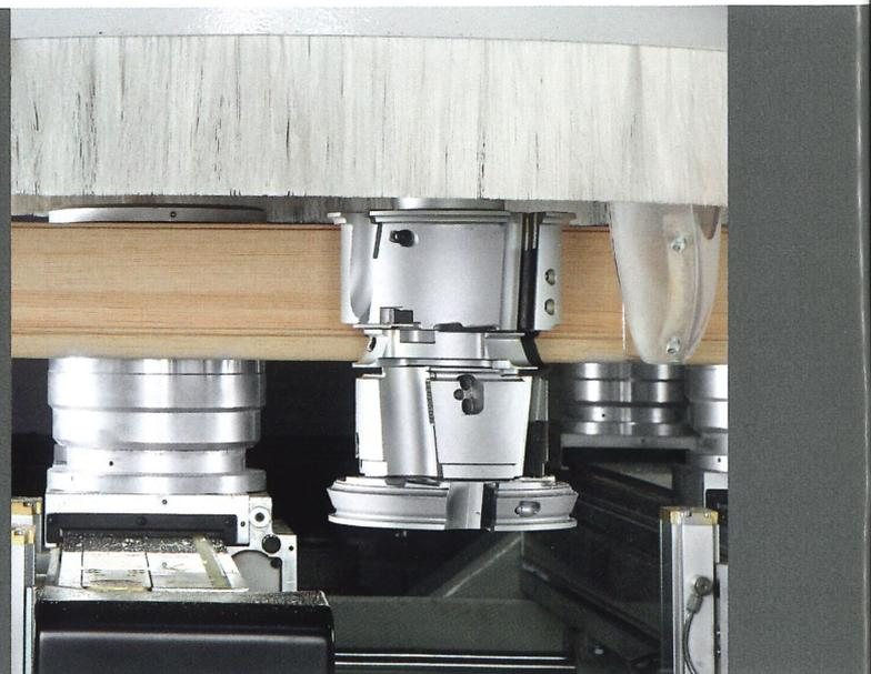
Saubere Arbeitsumgebung durch das Fördersystem, das den Abtransport von Spänen und Staub erleichtert. Erhältlich für Aggregate mit 3 oder 5 Achsen, geeignet für Werkzeuge mit Einzel- und Doppelprofil.
