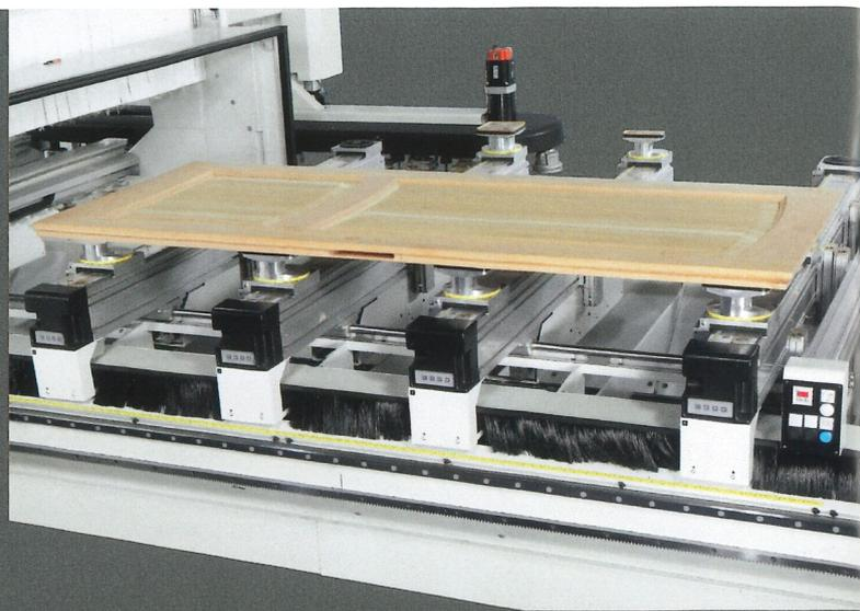
Matic ist der vollautomatische Arbeitstisch, der speziell zur Massivholzbearbeitung geeignet ist. Eine vollständige Konfiguration in nur wenigen Sekunden, da alle Schienen und Auflagen durch die unabhängige Motorisierung gleichzeitig verfahren. Zahlreiche technische Details sorgen für die dauerhafte Sicherheit und Zuverlässigkeit des Arbeitstisches.
