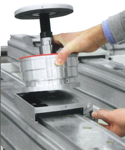
Praktischer und schneller Wechsel von Spannzylinder auf Sauger und umgekehrt. Der Bediener kann durch das von SCM entwickelte Schnellspannsystem per Knopfdruck und ohne Zuhilfenahme einer externen Vorrichtung arbeiten.
