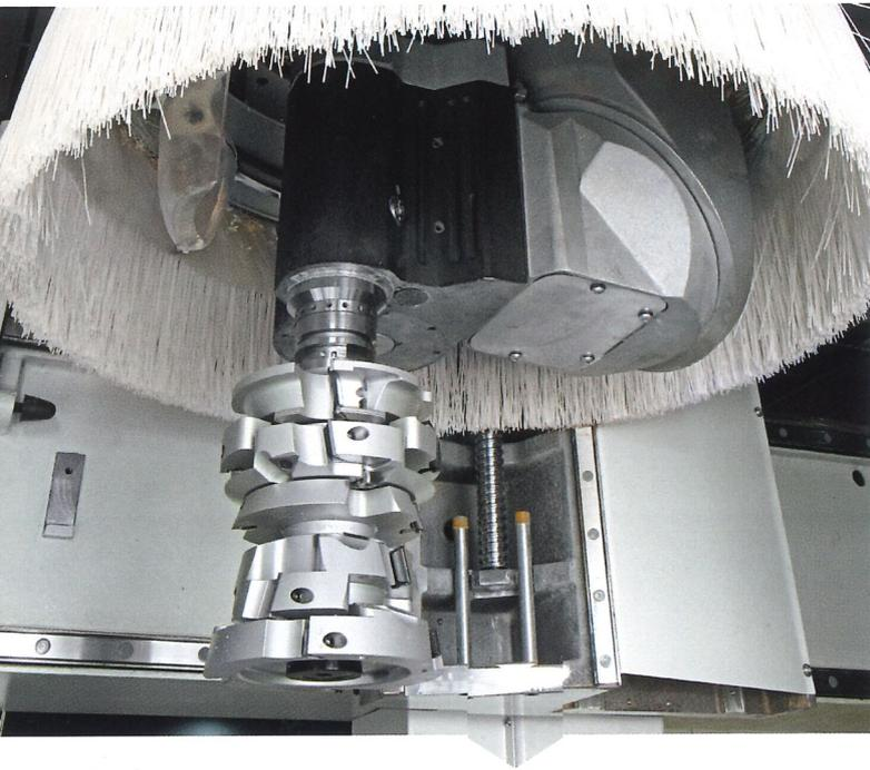
Die Elektroschneidspindel des SCM, mit Aufnahme HSK 63 E, sind leistungsstark und zuverlässig. Erlauben die Verwendung von Werkzeugen groß und mit Doppel-Profil gewährleistete einfache Profilierung von Teilen des großen Querschnitts.
