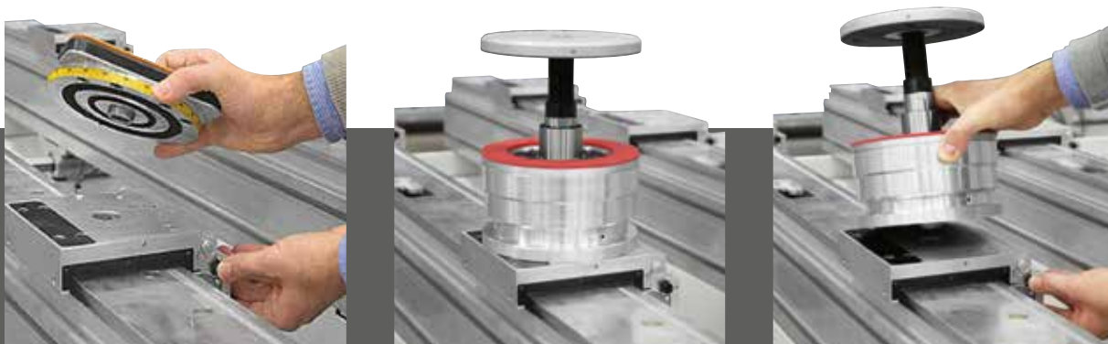
Praktischer und schneller Wechsel per Knopfdruck von Spannzylinder auf Sauger und umgekehrt durch das von SCM entwickelte Schnellspannsystem.
