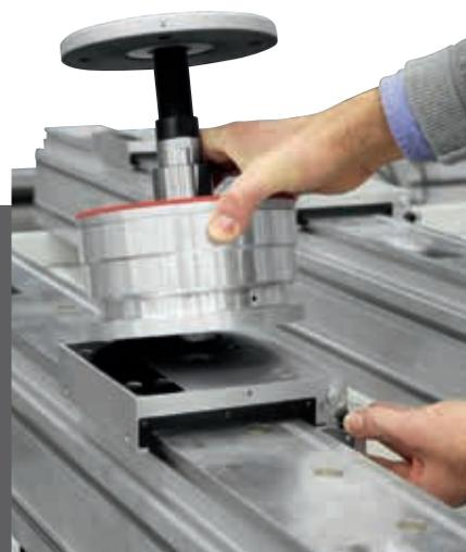
El acople rápido perfeccionado por SCM permite que el operador realice el cambio desde prensas a ventosas y viceversa, de manera práctica y rápida, sencillamente empujando un pulsador, sin necesidad de ningún otro medio externo.
