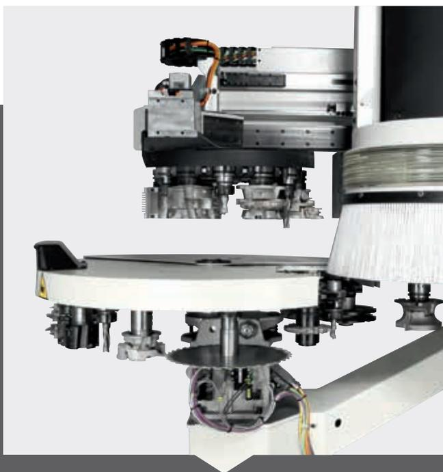
Accord fx tiene soluciones que se adaptan a cualquier producción, como el Rapid 12 on-board que permite el cambio de herramienta mientras la máquina está trabajando, y que se puede acoplar a otros almacenes suplementarios como el Rapid 16 o 24.
