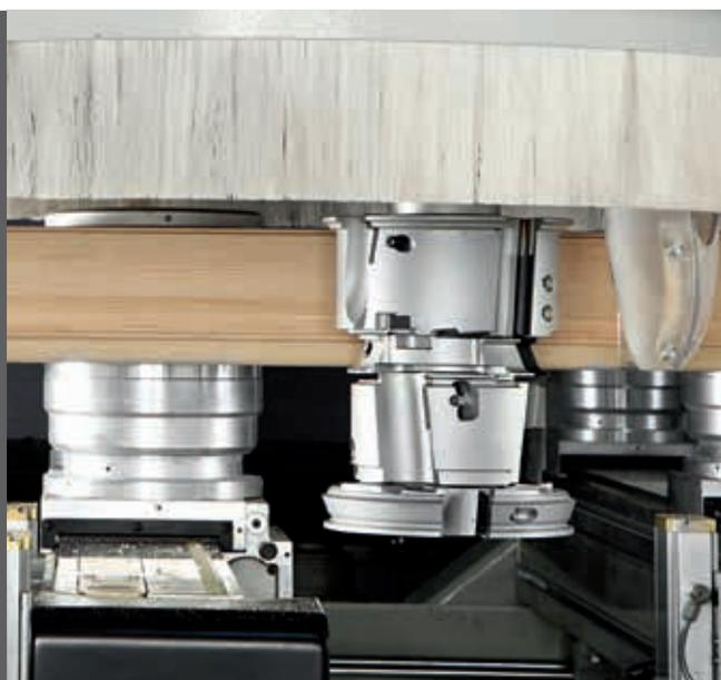
El ambiente de trabajo limpio con convoy que facilita la eliminación del serrín y del polvo generado por la elaboración. Disponible para grupos de 3 o 5 ejes, se puede utilizar tanto con herramientas de perfil simple como doble.
