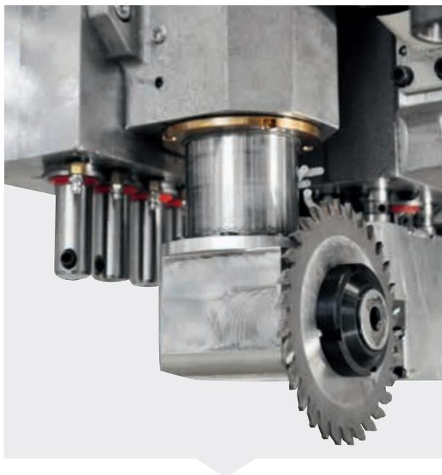
Con el grupo sierra integrado al cabezal de perforación con rotación de 0-90° se pueden realizar cortes longitudinales y transversales.
