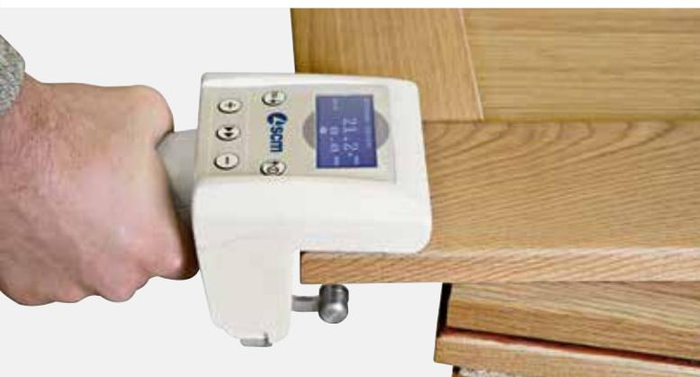
El **calibre electrónico wireless** permite colocar la máquina al espesor de trabajo medido por el propio dispositivo. **La comunicación a la máquina se produce sin hilos**, así mismo, se puede llamar por remoto el programa de trabajo deseado.
