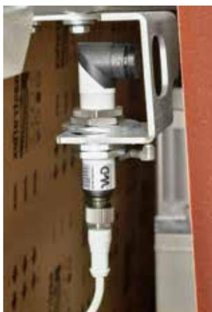
El sistema de centrado de la banda abrasiva está gestionado por una **fotocélula de “supresión del fondo”** extremadamente **precisa y fiable**, que garantiza un posicionamiento correcto.
