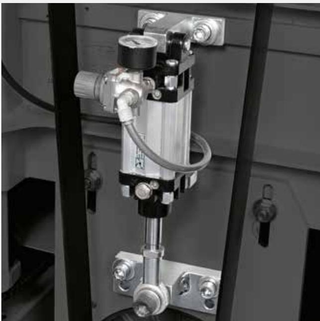
Los grupos rodillo constan de un sistema de auto-tensión de la correa que permite mantener constante en el tiempo la tensión correcta y garantiza la máxima eficiencia de transmisión de la potencia del motor.
