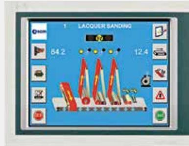
El control "PRO-SAND" permite establecer a través de touch screen todos los parámetros de trabajo y **comprobar en tiempo real el funcionamiento correcto** de la máquina.
