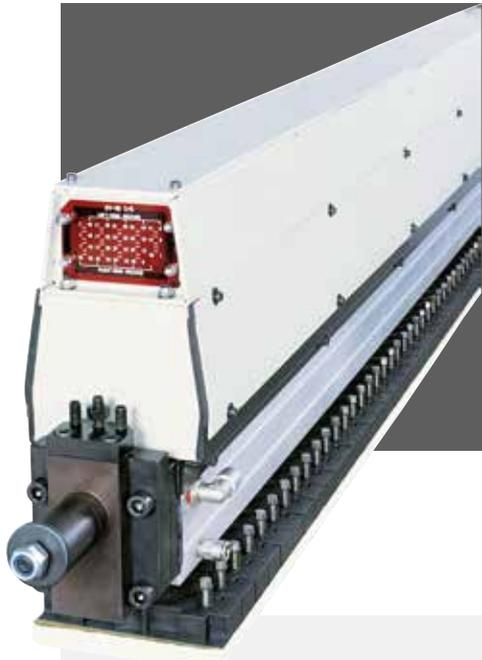
Le patin sectionné électronique "EPICS" se compose d'une poutre monolithique spéciale à l'intérieur de laquelle il y a des vérins activant les différents secteurs. Grâce à la course importante des vérins et au système à double effet (poussée/contrepoussée pneumatiques réglables), le patin "EPICS" assure le **maximum de précision et de sensibilité** pour n'importe quel type d'usinage.
