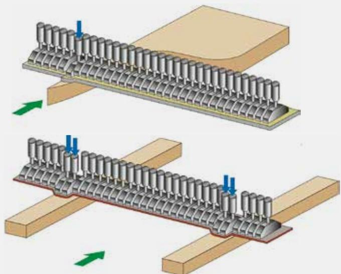
**LE NOUVEAU SYSTÈME « PWM » PERMET DE MODIFIER EN TEMPS RÉEL LA PRESSION D'EXERCICE DU PATIN ÉLECTRONIQUE « EPICS » EN L'ADAPTANT AUX DIFFÉRENTES ZONES DU PANNEAU.**
