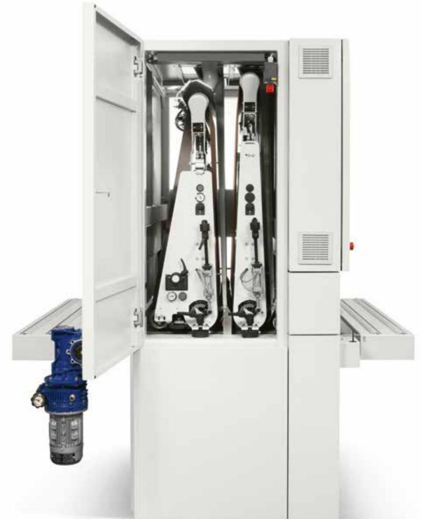
Sa **grande flexibilité** rend **dmc sd 70** idéale pour usinages diversifiés. Dans le secteur de l'ameublement (panneaux plaqués et vernis) cette machine se distingue dans la réalisation de **finitions de haut niveau**, grâce à **la longueur des bandes abrasives de 2.620 mm** et au patin sectionné électronique.
