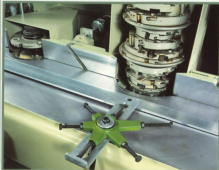
Der linke Profilanschlag mit einem **6-fach Revolver** erlaubt das Bearbeiten von Werkstücken unterschiedlicher Breite und wird bei Umrüsten auf das Umfälen einfach entfernt. Die automatisch einstellbaren rechten Profilanschläge erlauben den Einsatz der Werkzeuge auf der gesamten Werkstückhöhe oder nur auf einem Teilbereich.
