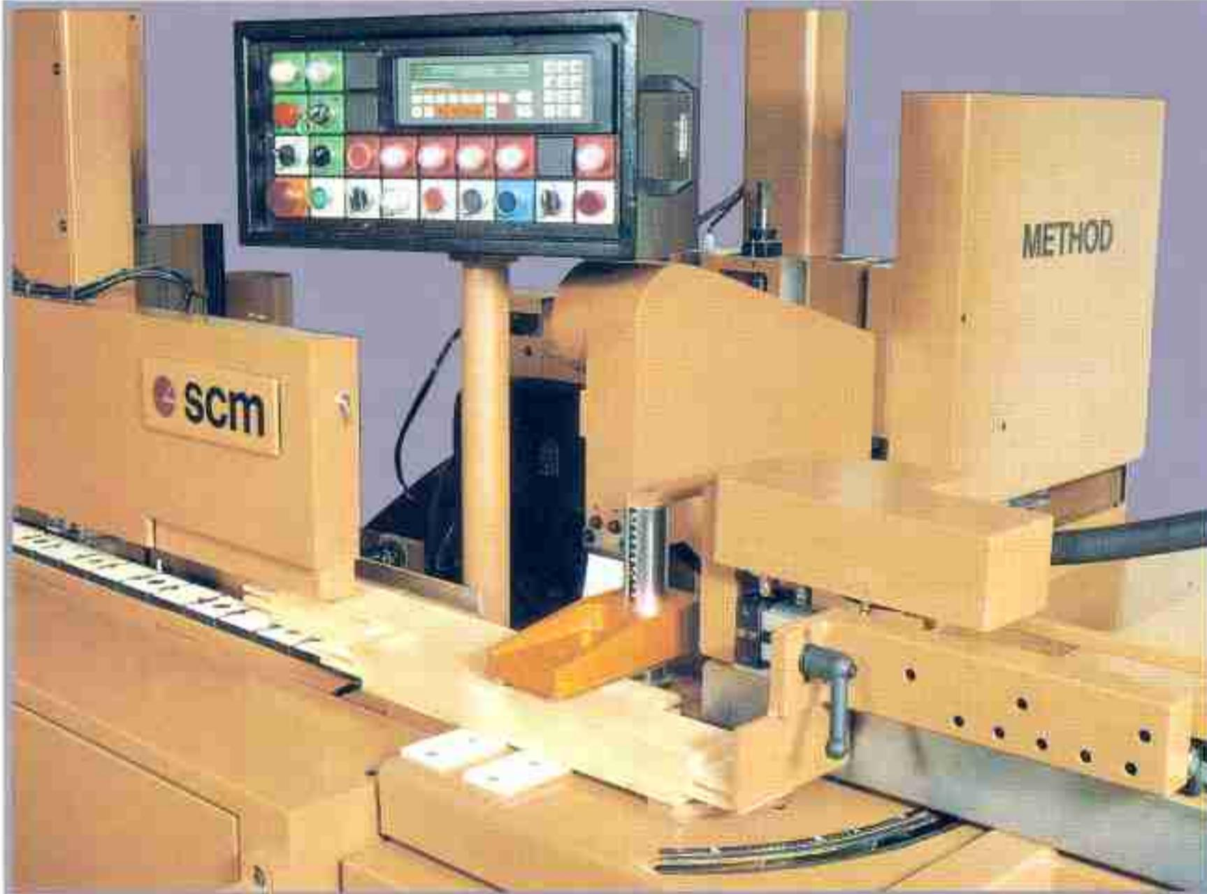
Possibilità di eseguire in sequenza pezzi di qualsiasi larghezza senza perdite di tempo, perché non ci sono guide da registrare.
