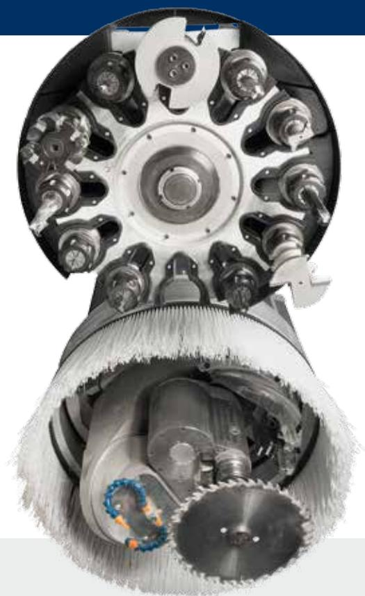
Ningún tiempo improductivo para el cambio de herramienta durante el trabajo con el almacén **RAPID 12 "on board"** instalado directamente sobre el grupo operador.
