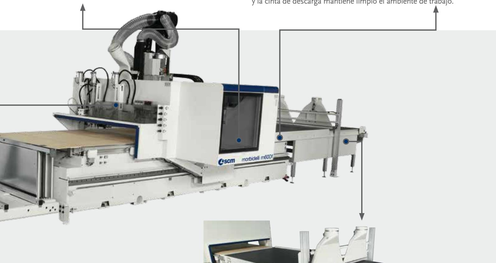
**Ningún polvo** con el sistema de aspiración superior para la limpieza de las piezas y el recolector de virutas posicionado al final de la cinta para eliminar cualquier residuo de trabajo.
