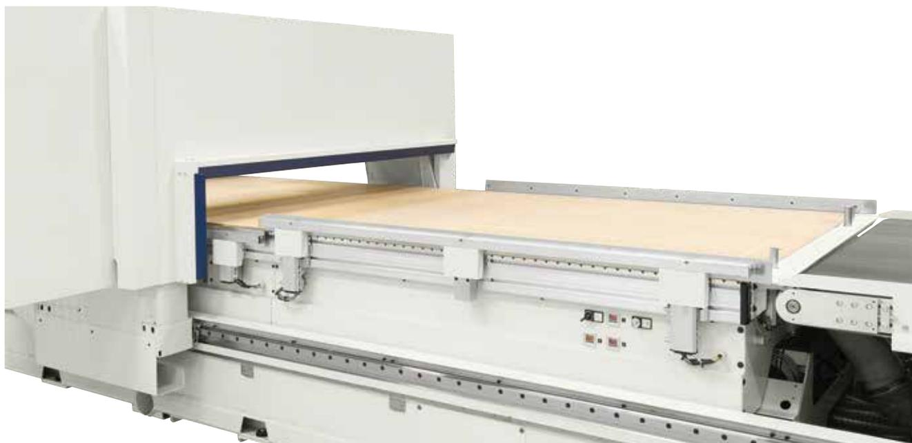
Pour une plus grande productivité, lorsque le matériel et les opérations le permettent, le système de chargement à ventouses peut positionner deux panneaux superposés sur le plan de travail.
