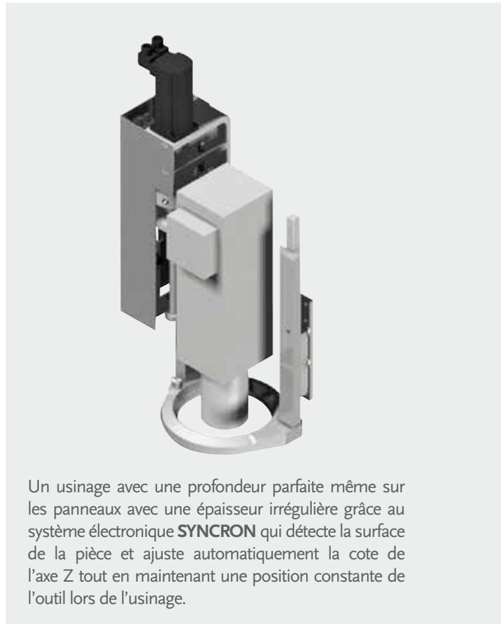
Un usinage avec une profondeur parfaite même sur les panneaux avec une épaisseur irrégulière grâce au système électronique **SYNCRON** qui détecte la surface de la pièce et ajuste automatiquement la cote de l'axe Z tout en maintenant une position constante de l'outil lors de l'usinage.
