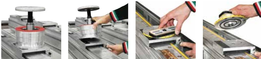
Remplacement facile et en des temps très brefs des ventouses ou des dispositifs à blocage mécaniques avec l'exclusif système de fixation rapide.
