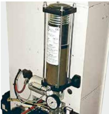
Lubrification centralisée automatique gérée par CN.
