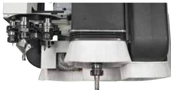
Höhere Produktivität und Verkürzung der Fertigungszeiten mit der zusätzlichen Fräsgruppe (PBTC) mit einer 12 kW-Elektrospindel und einem Rapid-Magazin mit 6 Positionen für einen Werkzeugwechsel während der Bearbeitung.
