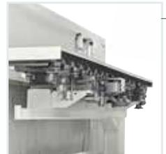
*Schnellere Arbeitszyklen dank dem **FAST** Werkzeugwechsler mit 14 Plätzen.*
