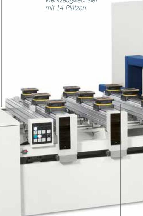
*Die **Arbeitstische TV FLEXDRIVE** und **TV FLEX** ermöglichen eine schnelle und bequeme Handhabung jeder Konsole in Abhängigkeit von der auszuführenden Bearbeitungsaufgabe.*
