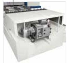
**Freiraum am Boden** dank der Vakuumpumpe, die im Maschineninnern integriert ist.
