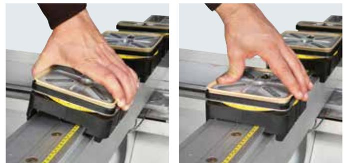
*Es ist möglich Sauger oder Spanner mit einer einfachen Handbewegung hinzuzufügen oder zu entfernen.*
