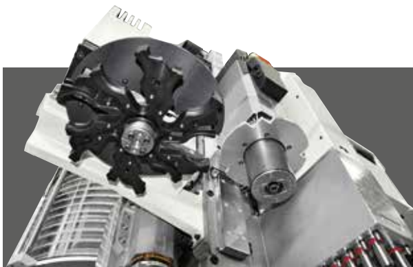
3-achsige Elektroschindel, optimal zur Durchführung von Plattenprofilierungen oder splitterfreien Bearbeitungen von bereits mit Kanten versehenen Platten ohne Werkzeugwechsel am Hauptmotor.
