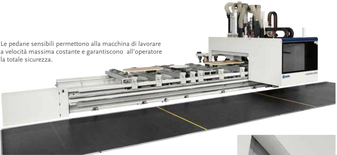
Strati sovrapposti di bandelle laterali a protezione del gruppo operatore, mobili per lavorare a massima velocità e totale sicurezza.
