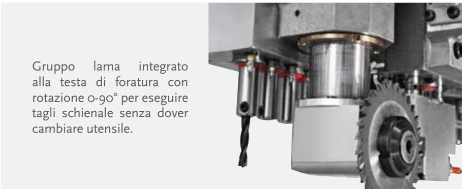
Gruppo lama integrato alla testa di foratura con rotazione 0-90° per eseguire tagli schienale senza dover cambiare utensile.
