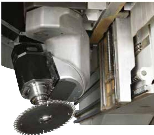
L'unità operatrice 4 assi, con potenze da 11 e 15 kW (S6) montato su un carro indipendente dall'unità di foratura, in grado di svolgere tutte le funzioni di fresatura verticale con utilizzo di teste per la finitura del bordo. Asse C  $\circ/360^\circ$  continuo ed alimentazione utenze pneumatiche per testine finitura bordo.
