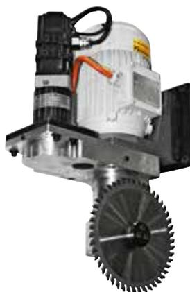
Gruppo lama a rotazione indipendente 0-360°, ideale per la sezionatura del pannello o l'**intestatura del bordo on-the-fly.**
