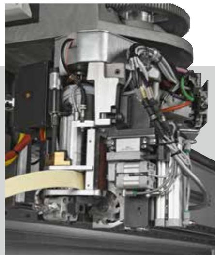
La vasca colla a cambio rapido dall'esclusivo disegno con rullo spalmatore dotato di resistenza integrata garantisce l'uniformità di incollaggio e la durata delle caratteristiche chimiche del collante per la miglior performance del prodotto.
