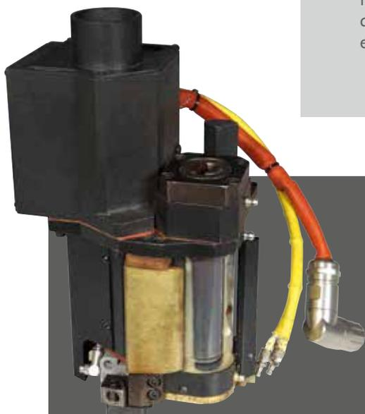
Il caricamento della colla avviene in tempo mascherato nel sistema di alimentazione granuli solidale al gruppo di incollaggio.
