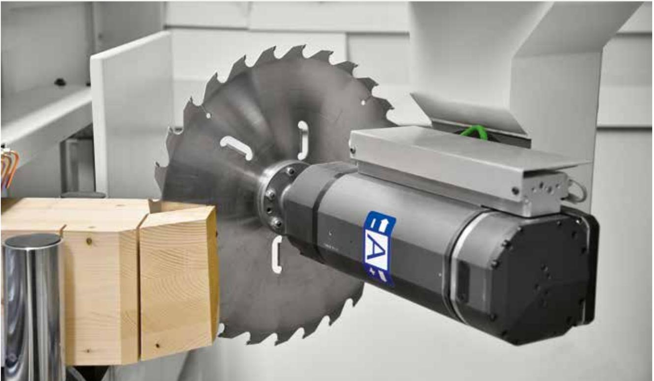
Von SCM entsprechend entwickelt und hergestellt, hat die Elektroschindel eine Leistung von **13 kW bei 6000 U/Min**, um die Leistung mit Werkzeugen großer Abmessungen auszunutzen und eine maximale Drehzahl von **16000 U/Min** zu erreichen. Ausgezeichnete Leistung, die die Maschine **ideal zum Fräsen mit schwerer Zerspanung und zum Profilieren bei hoher Drehzahl macht**. Präzision und höchste Qualität sind gewährleistet.
