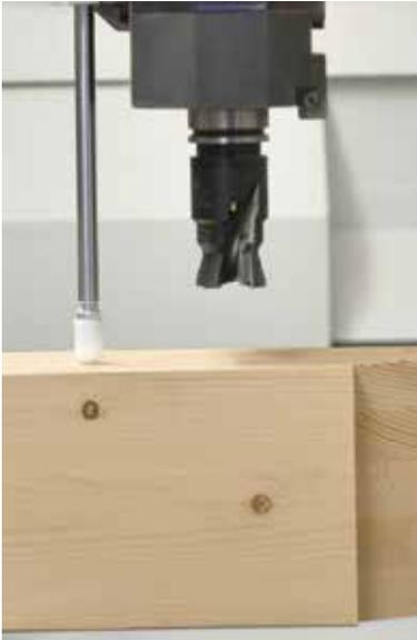
Die Werkstückoberfläche, an der die Bearbeitung durchgeführt wird, wird mit dem **pneumatischem Messgerät** gemessen; die Maschine korrigiert das Programm in Bezug auf das gemessene Maß; mit dieser Funktion wird die Bearbeitung mit größter Genauigkeit durchgeführt.
