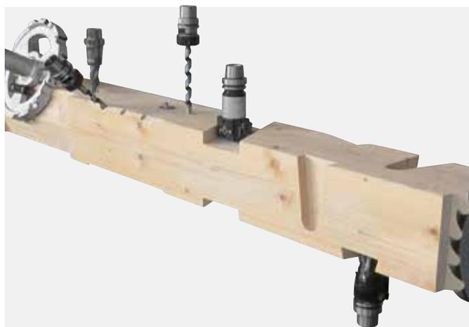
Balken und modulare Holzbauwände mit Querschnitt bis zu 1250x300 mm und Bearbeitungen auf alle Seiten, werden in einer einzigen Aufspannung verarbeitet, ohne das Stück zu kippen oder neu zu positionieren.
