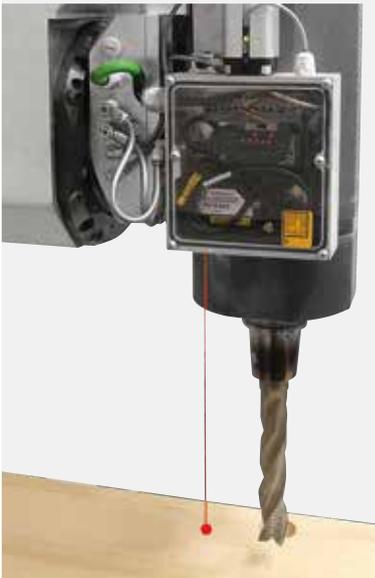
Die Werkstückoberfläche, an der die Bearbeitung durchgeführt wird, wird mit dem **Laser-Gerät** gemessen; die Maschine korrigiert das Programm in Bezug auf das gemessene Maß; mit dieser Funktion wird die Bearbeitung mit größter Genauigkeit durchgeführt.
