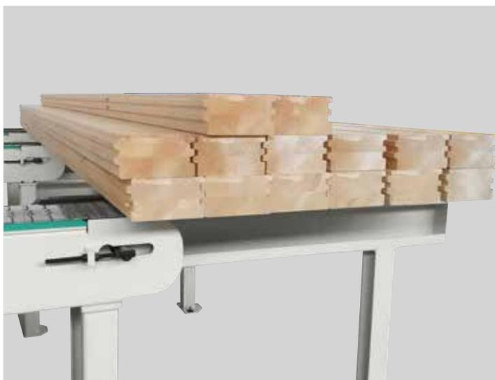
Bequem abnehmbare Stützen erleichtern die Beschickung von Stücken auf der Kette.
