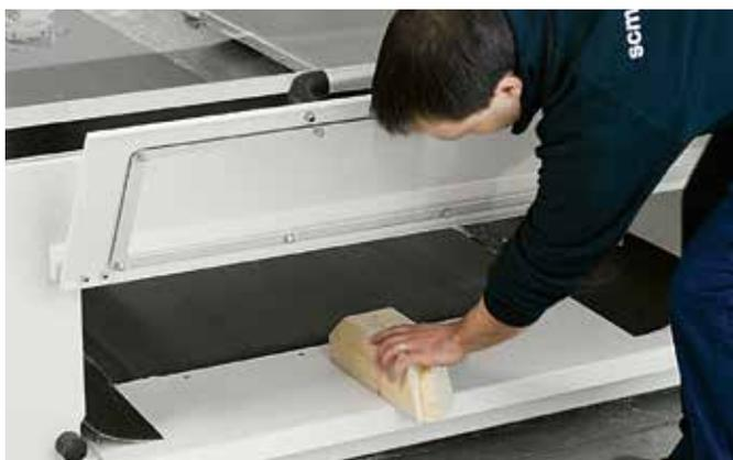
Späne und Abfälle werden mit einem breiten angetriebenen Band unter dem Bearbeitungsbereich nach außen transportiert. Die Laufbandrichtung kann umgekehrt werden, damit es möglich ist kurze schmale Teile nach vorne zum Bediener ausführen zu lassen.
