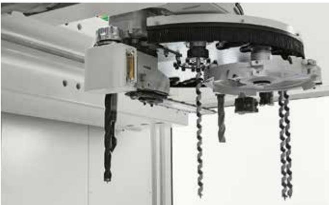
Werkzeugmagazine mit **bis zu 18 Plätzen**, um alle notwendigen Werkzeuge für die vollständige Bearbeitung immer On-Board zu haben. Der obere Platz kann ein **Sägeblatt von 600 mm Durchmesser** aufnehmen und der untere Platz erlaubt spezielle Winkelaggregate wie das Stemm-Schlitzaggregat einlegen zu können.
