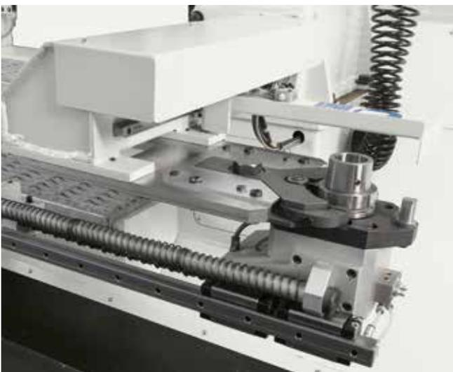
Spezifische Position für Stemm-Schlitzaggregat oder Werkzeuge mit einem Gewicht bis zu 15 kg.
