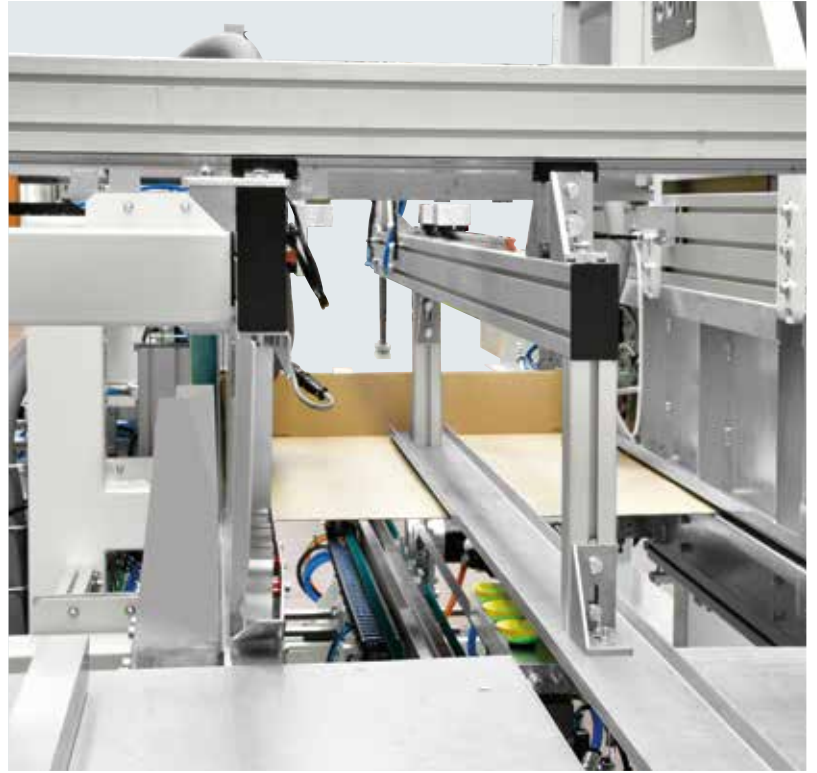
Automatische Formateinstellung nach Kartongröße.
