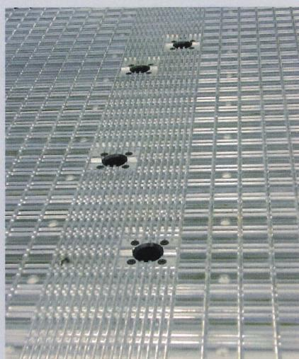
Piano di lavoro in alluminio estruso, multifunzionale, con doppia canalizzazione del vuoto su ogni semi area e scanalature superiori a passo 40mm.
