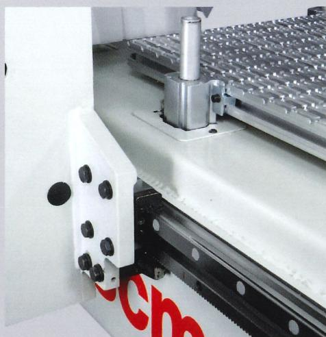
Cremagliera e pignone a denti elicoidali per la movimentazione degli assi X e Y che raggiungono una velocità vettoriale di 87 m/min.
