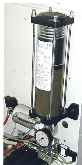
Lubrificazione Automatica gestita direttamente dal Controllo Numerico.
