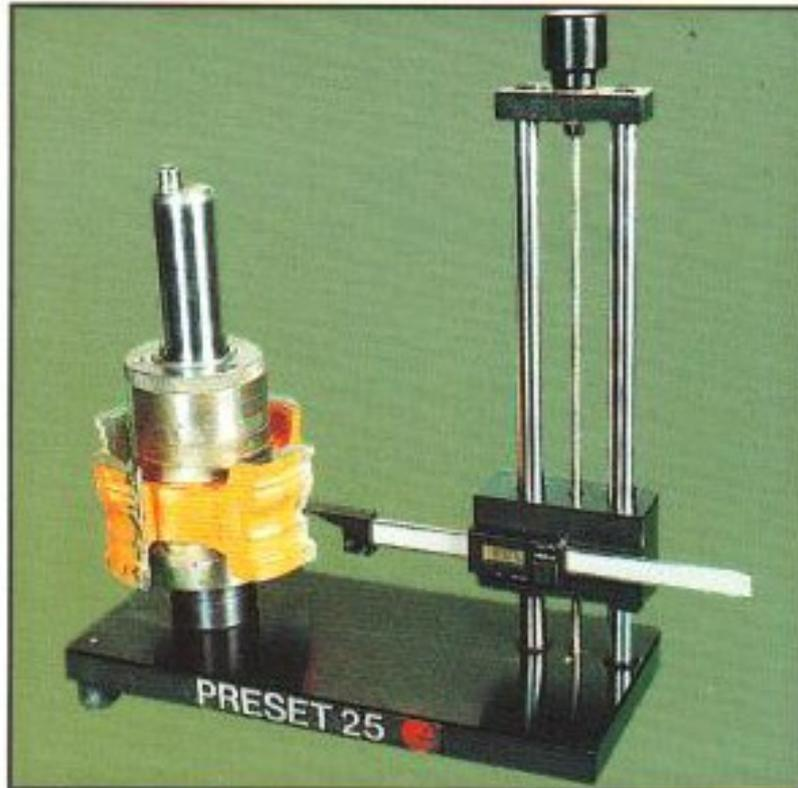
Das neue Werkzeug-Messgerät, PRESET 25, erlaubt eine schnelle und präzise Messen des Werkzeugdurchmessers: die Einstellung von Superset 23 wird noch rascher.
