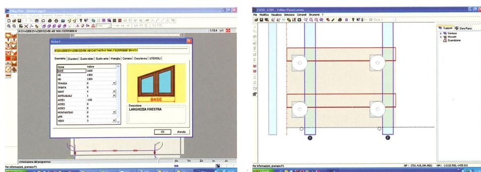
Per una produzione flessibile di finestre è necessario disporre di un sistema pratico, veloce ed intuitivo, che permetta di adattarsi in maniera rapida al variare delle dimensioni di ogni singola finestra. TVN SET è la piena risposta a questa esigenza. Attrezzato il piano con ventose o morsetti, al variare delle dimensioni del prodotto, è sufficiente modificare le quote nel programma parametrico e le barre si configurano per le nuove dimensioni.
